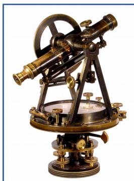
En 1901 Henry Yule Oldham met au point une autre façon de reproduire l'expérience de Wallace. Il place trois pôles alignés fixés à égale hauteur au-dessus du niveau de l'eau (toujours sur la rivière Old Bedford), et grâce à un Théodolite, il put déterminer que le pôle médian était 0.91m plus haut que les deux autres. Cette expérience prouvant que la terre est ronde fut par la suite enseignée pendant plusieurs années jusqu'à ce que des photos de la Terre prise de l'espace soient disponibles.
